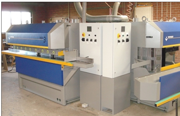
La tenonneuse et la profileuse de la machine sont disposées en angle, ce qui permet de travailler avec les deux machines simultanément et avec un seul opérateur
