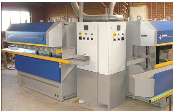
De pennenbank en de profileerunit van de ramenhoek staan in een hoekopstelling, waardoor er met beide machines gelijktijdig en met één bediener kan worden gewerkt
