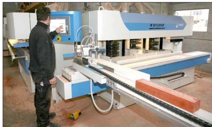
"De PenPro7 is simpel bedienbaar door één persoon die zich doorheen het hele proces niet hoeft te verplaatsen"
